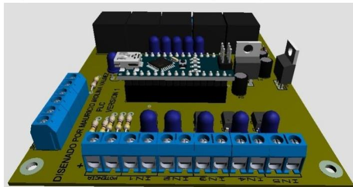
Figura 09. Vista Lateral Placa de Circuito Impreso 3D
