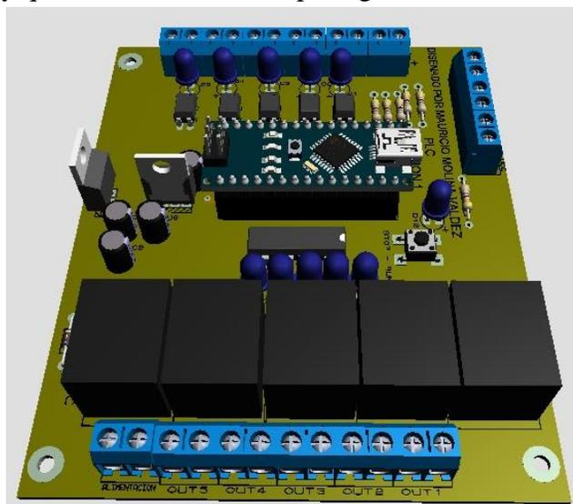
Figura 12. Vista Lateral 2 Placa de Circuito Impreso 3D (Molina Valdez, 2022).
